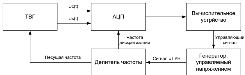
Рис. 1. Структурная схема обработки сигналов ТВГ
