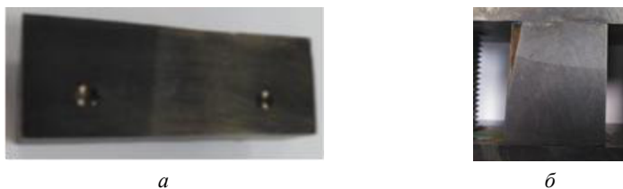
Рис. 5. Микрошлиф зоны сплавления рельсов: a – образец 1; б – образец 2
