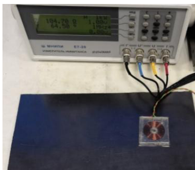
Рис. 1. Установка для измерения листов и матов ТРГ методом вихревых токов
