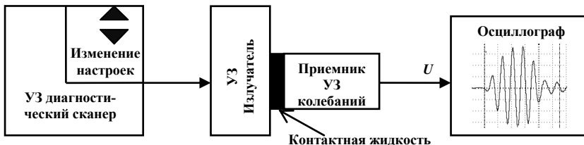
Рис. 4. Блок-схема измерения интенсивности УЗ-излучения
