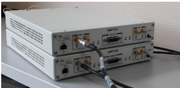
Рис. 5. Схема подключения ППМ USRP X310
