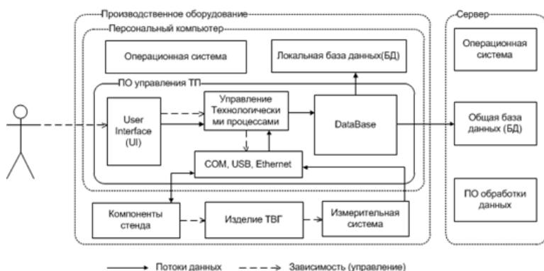
Рис. 1. Схема взаимодействия объектов с ПО
