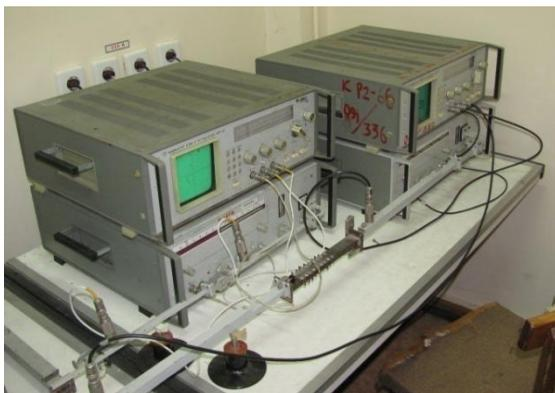
Рис. 2. Установка для измерения  $\epsilon$  и  $\text{tg } \delta$  на частотах выше 300 МГц
