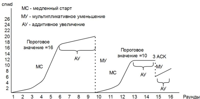
Рис. 4. Реакции протокола TCP на обнаружение перегрузки
