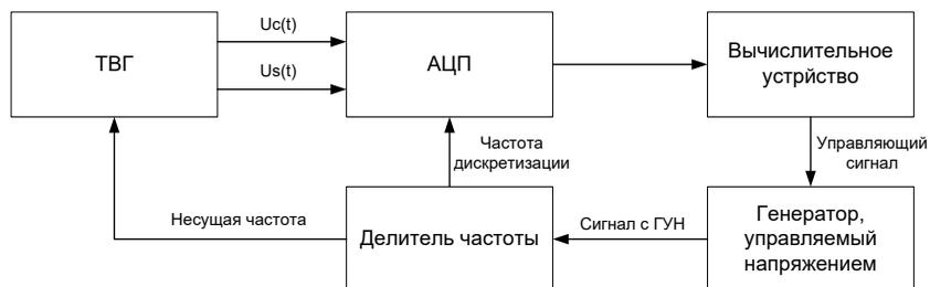
Рис. 1. Структурная схема обработки сигналов ТВГ
