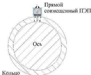
Рис. 1. Схема испытания образца натяга эхо-методом
