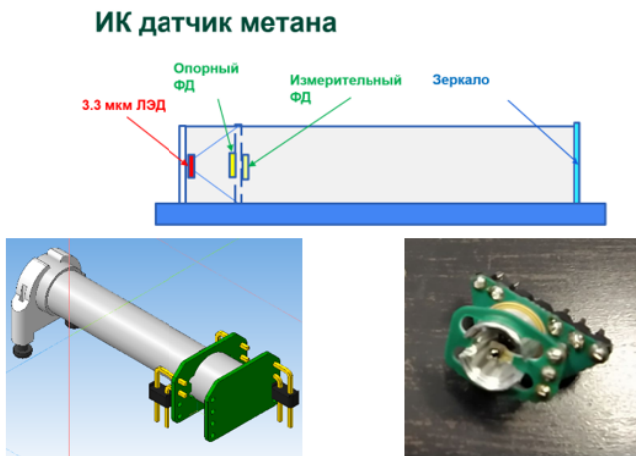
Рис. 2. Верхняя строка – принципиальная схема оптической ячейки. Нижняя строка – реализация оптической ячейки (длина ячейки – 40 мм)
