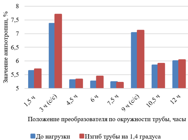
Рис. 4. Значения анизотропии относительно изгиба на расстоянии 2800 мм от торца
