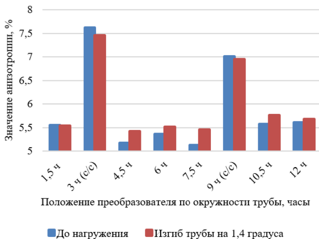
Рис. 5. Значения анизотропии относительно изгиба на расстоянии 3800 мм от торца
